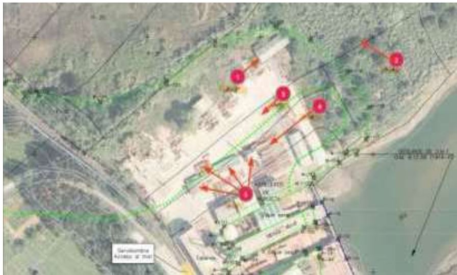
Ilustración 6: Sobre deslinde DPMT 2004, servidumbre modificada de 2023: (1) naves y tejavanas y acopios en servidumbre protección (2) relleno de lodos y arenas contaminados, convertido en vertedero permanente, (3) ubicación informada de Uralita enterrada, (4) Acopios de materiales ferrosos y más casetas, (5) contenedores, casetas y maquinaria invadiendo el servidumbre de litoral actual.
